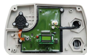
Carte électronique logée dans un boîtier IP 65, et enduite de résine afin d'assurer une protection contre l'humidité optimale. T° du liquide: 65°C maxi / ambiante: 40°C maxi.
